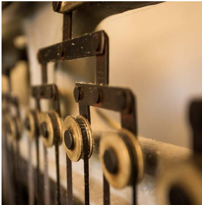
Die Lederstiftenmessmaschine berechnet die Größe eines Leders (Einheit: 1 Engl. Quadr.-Fuß = 9,29 Quadratdezimeter) millimetergenau, indem sie die Haut über ein Räderwerk abstastet (Fotos o. und u.). Rechts: Thomas öffnet das Gerbfass.
