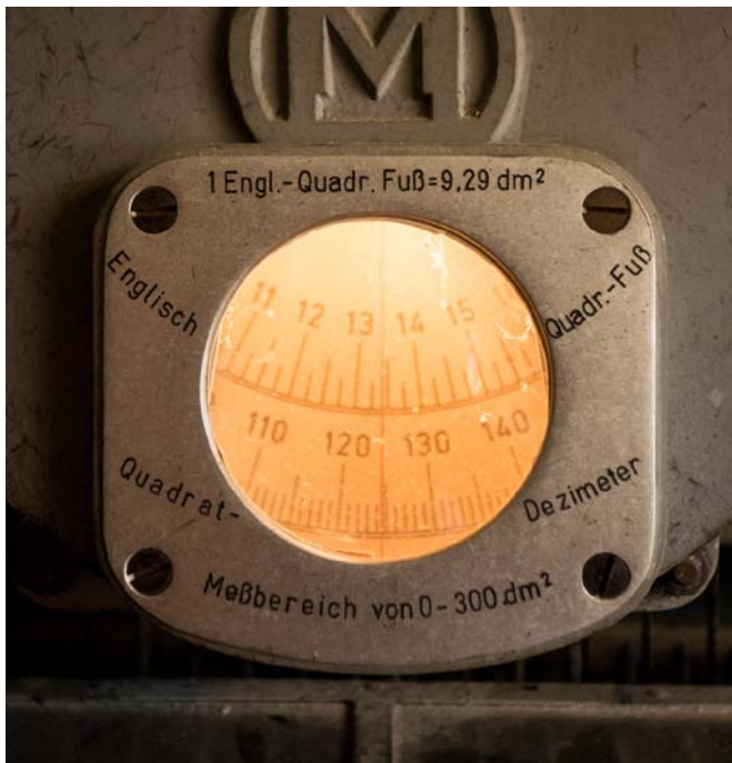
Die Lederstiftenmessmaschine berechnet die Größe eines Leders (Einheit: 1 Engl. Quadr.-Fuß = 9,29 Quadratdezimeter) millimetergenau, indem sie die Haut über ein Räderwerk abstastet (Fotos o. und u.). Rechts: Thomas öffnet das Gerbfass.
