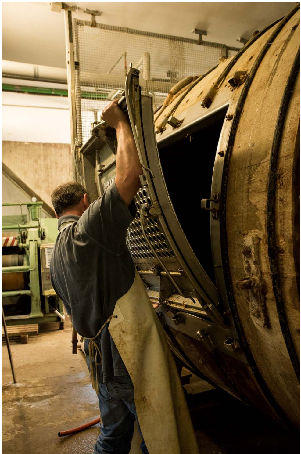
Die Lederstiftenmessmaschine berechnet die Größe eines Leders (Einheit: 1 Engl. Quadr.-Fuß = 9,29 Quadratdezimeter) millimetergenau, indem sie die Haut über ein Räderwerk abstastet (Fotos o. und u.). Rechts: Thomas öffnet das Gerbfass.
